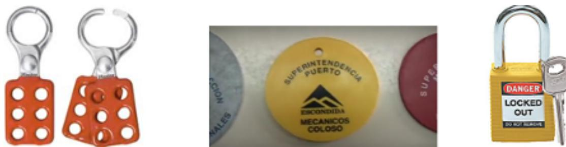
Tenaza de Bloqueo: Dispositivo mecánico utilizado para instalar el candado de bloqueo. Este dispositivo debe ser de material resistente a la palanca de manera que no pueda ser removido fácilmente. Posee un numero de posibilidades (6) para instalar varios candados de bloqueo u otras tenazas sobre la misma. Ver figura 3.20.
