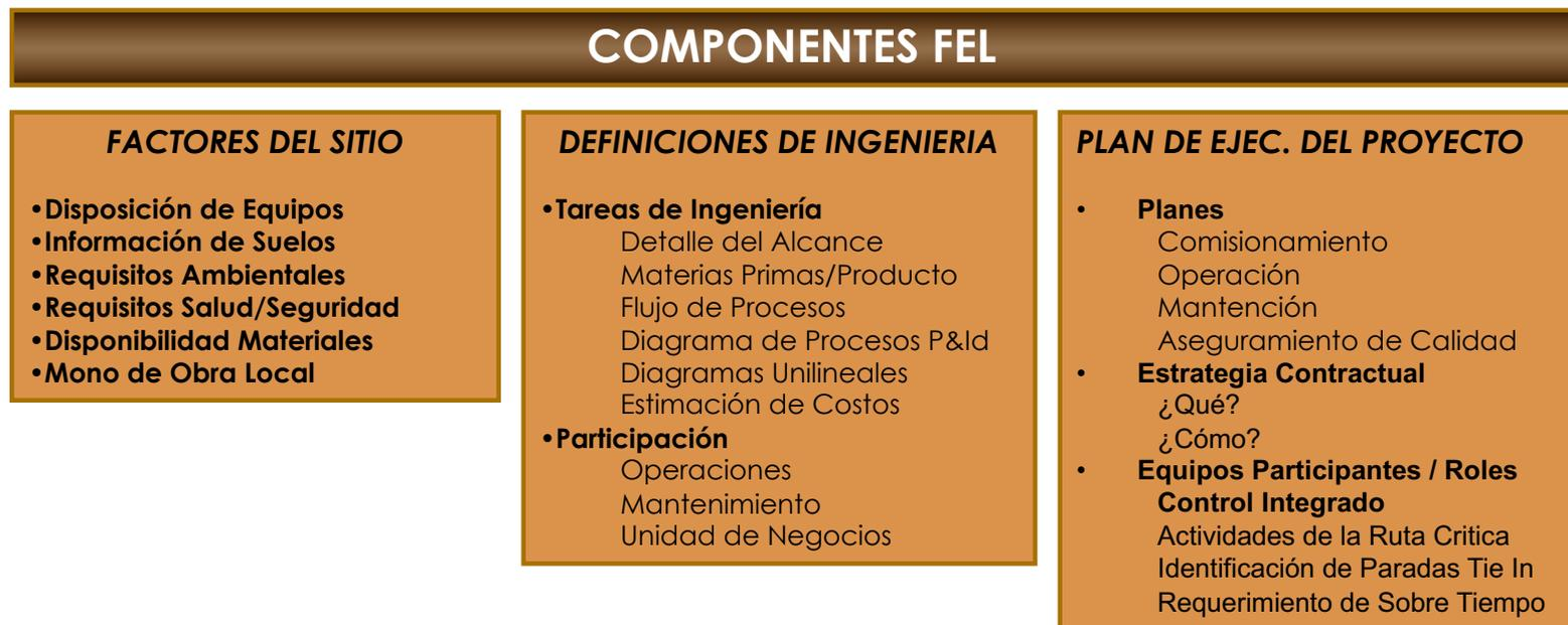
FEL es un proceso que tiene por objeto lograr un conocimiento detallado del proyecto de modo de minimizar los cambios en la etapa de ingeniería de detalles, adquisiciones y en la fase de ejecución del proyecto (construcción y montaje, termino de construcción, precomisionamiento y comisionamiento).
