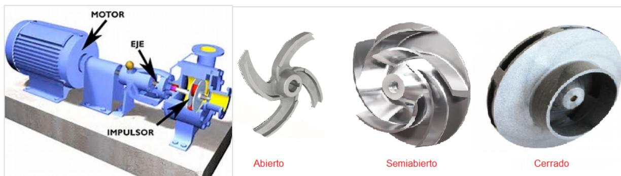
La carcasa de la bomba, también puede ser de diferentes diseños, tiene la función de hacer la conversión de energía cinética o de velocidad que se imparte al fluido por el impulsor, en energía de presión o potencial. Existen dos tipos básicos de carcasas: de tipo espiral y de tipo difusor. En la carcasa de tipo espiral (voluta), el impulsor descarga el fluido en un área que se expande gradualmente, disminuyendo así la velocidad para irse convirtiendo en energía de presión. Ver figura 85.
