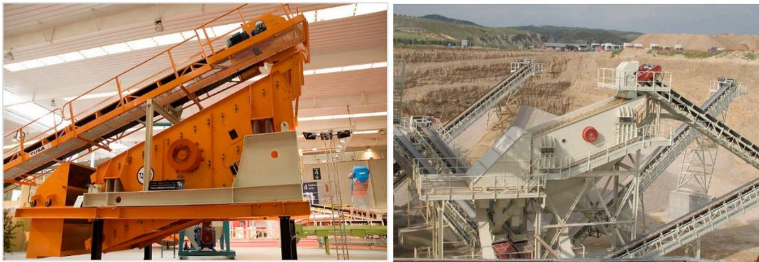
Figura 56 Disposición de harnero bajo molino de barras
