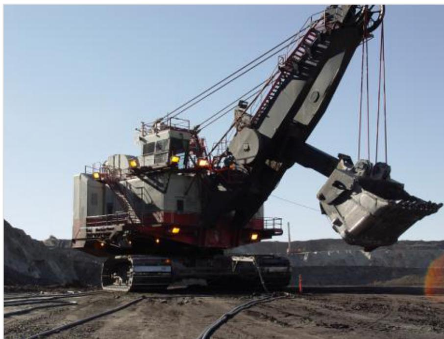
Las palas eléctricas tienen capacidad para cargar hasta 100 toneladas de material de una sola vez, por lo que realizan habitualmente *tres pases* para cargar un camión. Los cargadores tienen menor capacidad y en minas de gran tamaño solo son utilizados para trabajos especiales. Una pala grande necesita un frente de carguío mínimo de 65 metros de ancho y carga camiones que se van colocando alternadamente a cada lado de ella.
