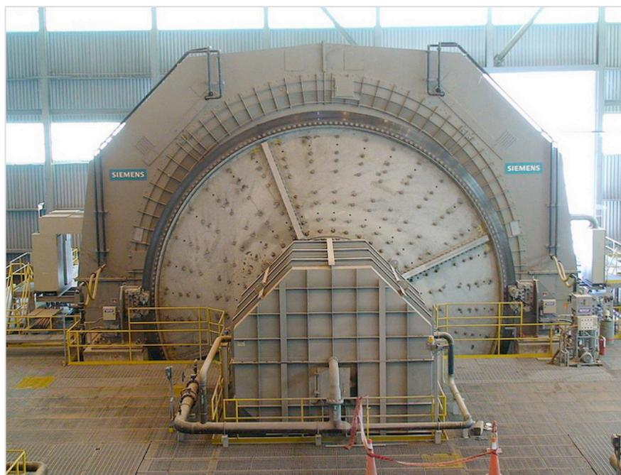
Los tamaños de los molinos de SAG diseñados, fabricados y puestos en operación en las diferentes plantas a través del mundo alcanzan ya tamaños de 18' de largo con 38' de diámetro con potencias de hasta 27.000 HP. Los molinos SAG ofrecen hoy día un
