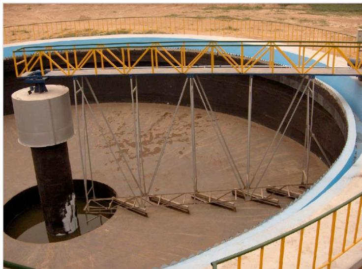
En este equipo la pulpa ingresa al tanque y el espesador separa los líquidos de los sólidos, luego los sólidos se descargan por la parte inferior del tanque. Su mecanismo de agitación está diseñado para que haga una vuelta cada 13 o 12 minutos. Es muy lento, de tal manera que los sólidos comienzan a sedimentarse. Para optimizar este proceso un floculante adecuado es muy importante.
